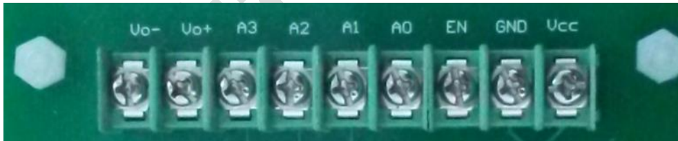
图 2 水表演示板的电气接线端
